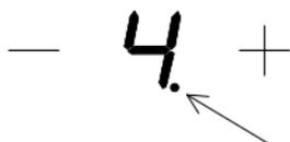
Chaque degré de puissance de chauffage de 1 à 9 est suivi d'un niveau intermédiaire signalé par le chiffre donné et par un point (par exemple 4.)
